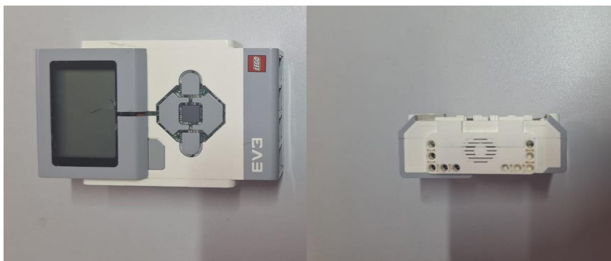
Figura 2 – Brick (EV3) utilizado
