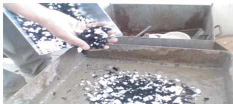
Dos concretos manufacturados foram confeccionados 8 corpos-de-prova, 4 para cada concreto (com e sem borracha e EPS). Para serem submetidos à compressão no laboratório de metrologia do CEFET-PI com idade de 56 dias, Seguindo as recomendações normativas da Associação Brasileira de Normas Técnicas, NBR 7215 [4]. Os corpos-de-prova fora deixados fora da câmara úmida.
